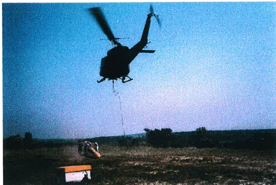
Abbildung 4-2: Aerogeophysik- Meßausrüstung ( http://www.geolba.ac.at )
