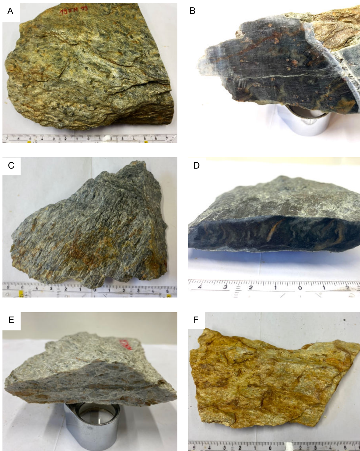
Abbildung 12: A: Granate auf den S-Flächen (Probe 19FM19), B: Granat in Schnittfläche (Probe 19FM22), C: Lineationen auf S-Flächen (Probe L01), D: Quarzkauern in Schnittfläche (Probe L04), E: S-C-Gefüge in Schnittfläche (Probe 19FM20), F: Serizitquarzit (H01)
